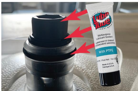
Appliquer le lubrifiant et enduit d'étanchéité à ces **trois endroits**.
